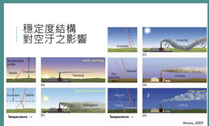
圖（六）不同邊界層穩定度結構下，污染物的擴散情形。(Ahern, 2009)
